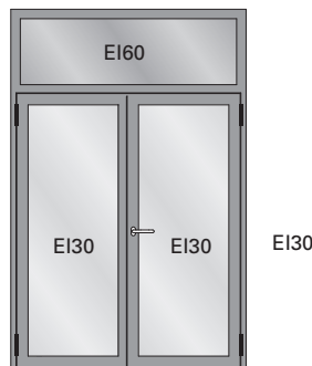
Zweiflügelige Türe mit festem Oberlicht Porte à deux vantaux avec imposte fixe Double leaf door with fixed top light
