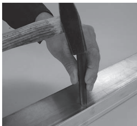
Einschlagen der Tülle mit Montage- werkzeug 499.318 und Stahlhammer (Achtung: Unterlagen verwenden)
