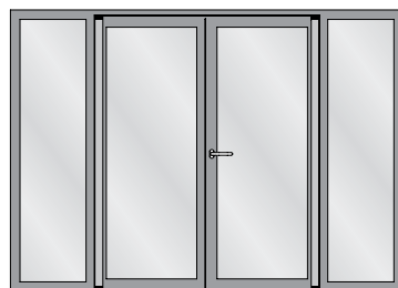
Zweiflügelige Türe mit zwei Seitenteilen Porte à deux vantaux avec deux parties latérales Double leaf door with two side lights
