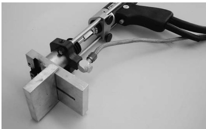
Abb. 3 Schweiß-Pistole mit Schweißlehre 499.214 Ill. 3 Pistolet à souder avec gabarit de soudage 499.214
