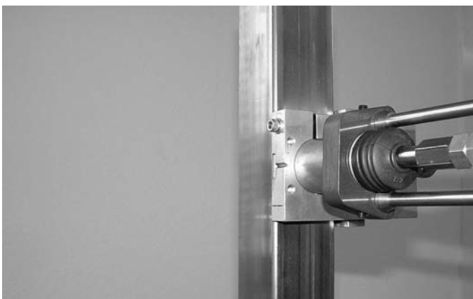
Abb. 13 Beim vertikalem Einsatz der Bolzenschweissung und bei starkem «Verblasen» des Schweißbades empfehlen wir als Hilfsmittel einen Keramikring einzusetzen III. 13 Nous vous recommandons d'utiliser une bague céramique comme auxiliaire en cas d'application verticale du soudage à l'arc avec percussion du soudage des goujons et de fort soufflage du bain de soudure
