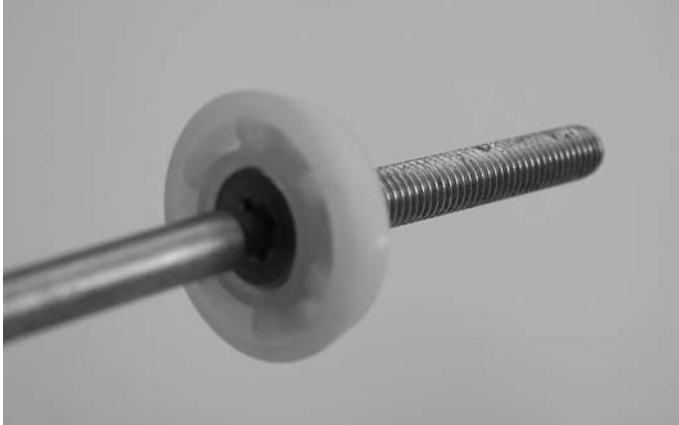
Abb. 27 SR1 schraube M 5 mit Zentrierscheibe auf Schraubklinge SR1 aufgesteckt
