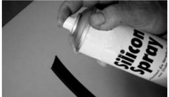
Dichtungen mit Silikon besprühen Vaporiser les joints avec du silicone Spraying the weatherstrips with silicone
