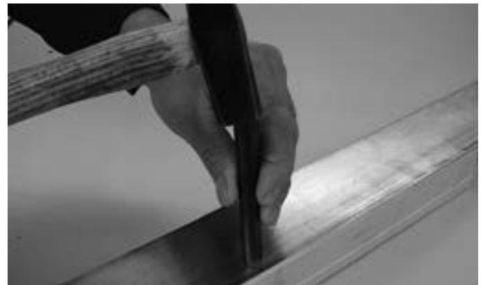
Einschlagen der Tülle mit Montagewerkzeug 499.318 und Stahlhammer (Achtung: Unterlagen verwenden)
