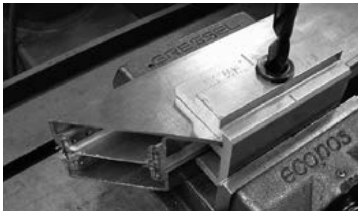
Bohren mit Ständer-Bohrmaschine Perçage des trous avec perceuse verticale Drilling using upright drilling machine
