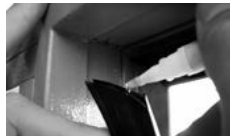
Gehrungsecken verkleben Coller les angles d'onglet Gluing the mitre corners
