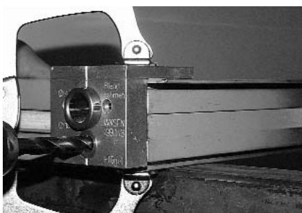
Abb. 23 Standflügel unten (Sockelprofil 601.685)
