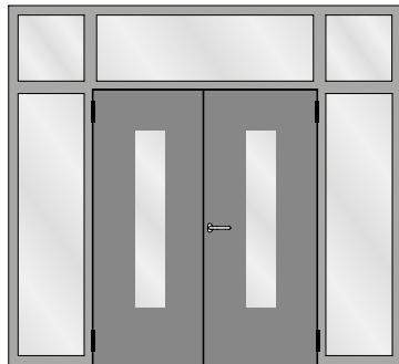
Verblechte zweiflügelige Türe mit zwei festen Seitenteilen und festen Oberlichtern Porte tôle à deux vantaux avec deux parties latérales fixes et impostes fixes Sheet metal double leaf door with two fixed side lights and fixed top lights
