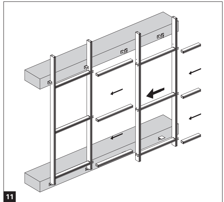
Kombination Rahmenbauweise / Steckbauweise Construction par élément / méthode de construction modulaire Element construction / Push fit construction Costruzione ad elementi / costruzione modulare
