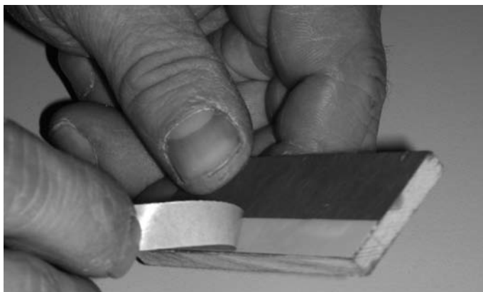
Abb. 88 Klebeband-Schutzfolie abziehen Fig. 88 Retirer la feuille de protection de la bande adhésive
