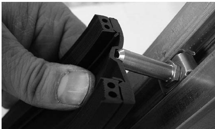
Abb. 30 Zentrierung durch Führungsnute auf Rückseite der Dichtung
