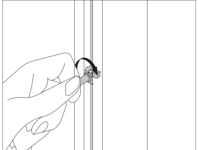
Abb. 29 Mit einer Rechtsdrehung wird der Brandschutzanker fixiert
