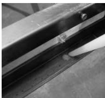
Abdichten lappenseitig Étancher côté aile fixe Sealing on the lip side
