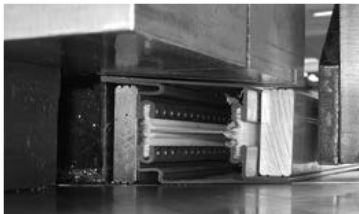
Zuschnitt Janisol-Türprofile Découpe des profilés Janisol Cutting Janisol door profiles
