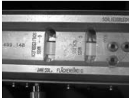
Bohrlehre auf G-Mass des Schlosses fixiert Gabarit de perçage fixé à la cote G de la serrure Drilling jig fixed to the G measurement of the lock
