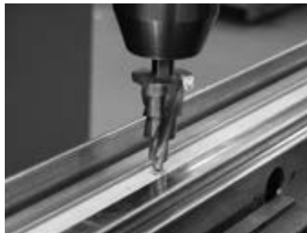
Schlitzmarkierung mit Universalbohrer 499.340 aufbohren Perçage du marquage de la fente avec foret à étages 499.340 Drill out the slot marking using multipurpose step drill 499.340
