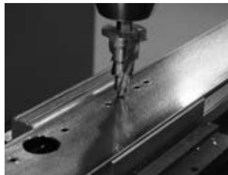
Markierungsbohrungen für Drücker und Zylinder aufbohren Forage des perçages de marquage pour poignée et cylindre Drill out the marking holes for the handle and cylinder
